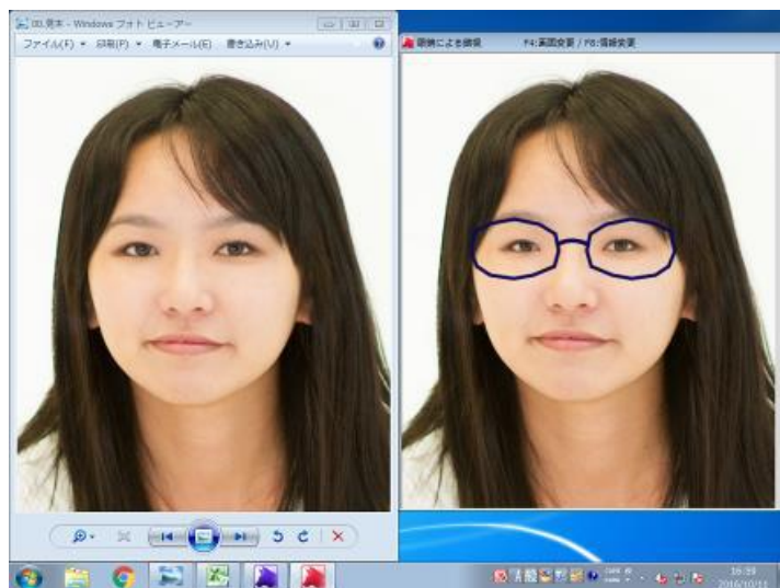
図 3 実験画面(左は裸眼画像、右の眼鏡装用画像の目の大きさはキーボード操作で変えることができる)
