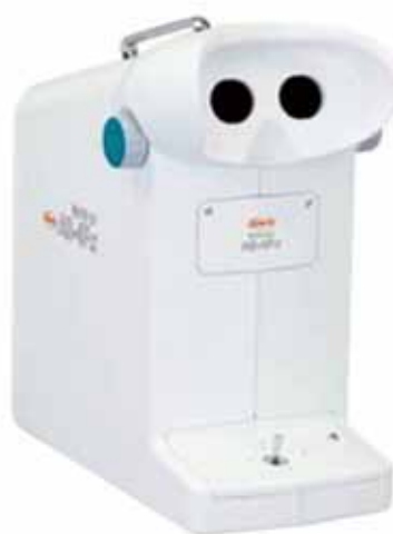
図 2-1 動体視力計：視力測定器のように測定器の中を見て、ランドルト環が手元に近づいてくるので、環の切れ目が認識できたときボタンを押して合図するやり方で測定される。
